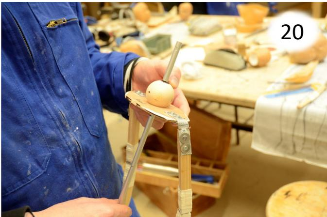
La boule de bois est percée pour insérer/coller le rond d'aluminium, qui dépasse au-dessus de la boule pour venir fixer la tête grâce à la mousse PU (voir guide 2, vignette 24)
