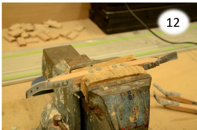
La sangle est boulonnée/collée. On réalise l'assemblage avant de le replacer dans le buste. Pour le coude, il y a juste une sangle boulonnée/collée.
