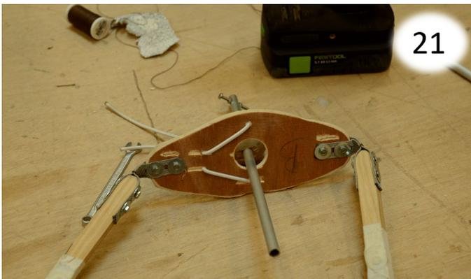
La boule est assemblée à la plaque de contreplaqué à l'aide d'un élastique qui la traverse ainsi que la plaque en deux points. Dans la boule, l'axe de cet élastique doit aller de la face vers le dos.
